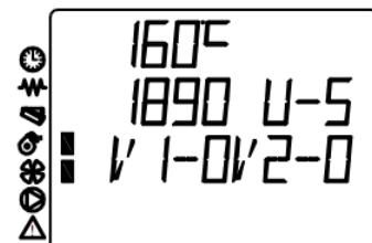
Pritiskom na taster 5 i zadržavanjem tastera pojaviće se sledeći izgled ekrana. Ova opcija je namenjena za peći za etažno grejanje, tako da kod obične peći nema nikakvu namenu. Ovde se mogu videti podaci o zadatoj temperaturi vode u kotlu, kao i pritisak u kotlu. Jednostavnim pomerajem prsta sa tastera, ekran će se vratiti na osnovni meni.
