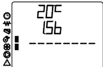
Pritiskom na taster 6 i zadržavanjem tastera pojaviće se sledeći izgled ekrana. Ovde se mogu videti podaci o preostalom vremenu do sledećeg režima rada peći. Jednostavnim pomerajem prsta sa tastera, ekran će se vratiti na osnovni meni.
