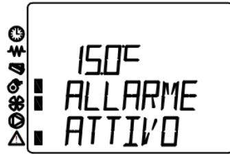
Greška se može javiti usled zaglavljivanja ventilatora, kao i usled neispravnosti kontakta koji napajaju ventilator el. energijom ili usled prekida kablova koji mere broj obrtaja ventilatora. Ako se javi ova greška obavezno kontaktirati servis. Neispravnost ventilatora može se uočiti i pritiskom na taster 2 injegovim zadržavanjem, tako što na mestu gde bi trebao da bude ispisano broj obrtaja ventilatora, stoji **000**.
