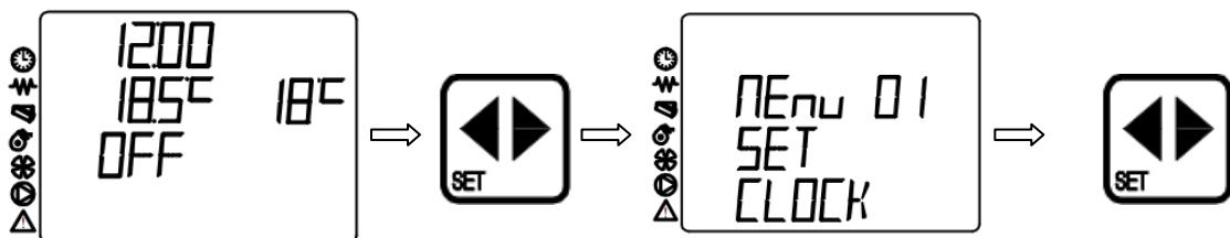
Na ekranu će se pojaviti sledeća poruka **menu 01** i ispod toga isписан dan koji je trenutno postavljen. Svetleći indikator za podešavanja će početi da treperi. Pritiskom na tastere 1 i 2 se menjaju dani i to na sledeći način:
