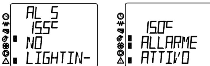
Greška se može javiti usled neispravnosti sonde koja meri temperaturu izduvnih gasova, usled niske temperature izduvnih gasova, nedovoljne količine peleta koja je potrebna za paljenje ili usled neispravnosti upaljača.
