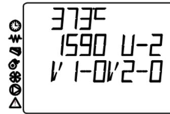
**Visoka temperatura izduvnih gasova.** Kada temperatura izduvnih gasova pređe fabrički zadatu vrednost, pojaviće se na ekranu poruka **HOT EXHAUST**. Peć će automatski preći u niži režim rada i smanjiti temperaturu izduvnih gasova. Ako se ova poruka često javlja pozvati servisera. Peć se može koristiti u nižim režimima rada od onih u kojima se ova poruka pojavljivala.
