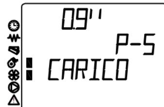
Pritiskom na taster 2 i zadržavanjem tastera pojaviće se sledeći izgled ekrana. Ovde se mogu videti podaci o temperaturi izduvnih gasova, režimu rada peći, brzinama ventilatora za kanalsko odvođenje toplote (opcije). Jednostavnim pomerajem prsta sa tastera, ekran će se vratiti na osnovni meni.
