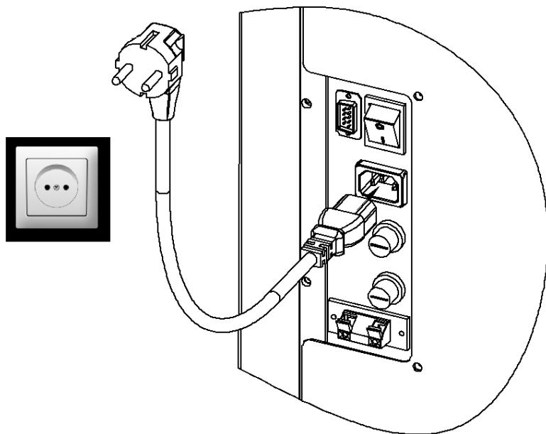
*Slika 5. Povezivanje peći na izvor električne energije*
