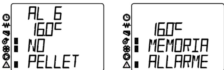
Poništiti alarm, pritiskom na taster 4, sačekati da se peć ohladi. Potom, postupiti prema upustvu opisanom u odeljku **8.7 POČETNO UBACIVANJE PELETA** i startovati peć.
