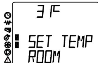
Podešavanje režima rada peći vrši se pritiskanjem na taster 6. Režime rada je moguće menjati od P1 do P5. Režime rada je moguće menjati tasterima 5 i 6, što će biti propraćeno porukom **SET OUTPUT**. Što je režim rada veći peć će brže postići zadatu temperaturu, nakon čega će se prebaciti u **WORK MODULAT**, što znači da je peć dostigla zadatu temperaturu i sada će sa smanjenim režimom održavati tu temperaturu.
