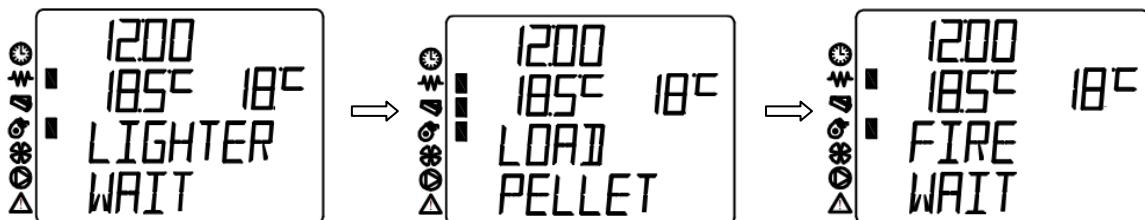
Naizmenično će se smenjivati poruke **LOAD PELLET** i **FIRE WAIT**, sve dok temperatura izduvnih gasova ne pređe  $40^{\circ}\text{C}$ , što je potrebno kako bi se detektovao plamen i kako bi peć mogla da počne sa radom. Maksimalno vreme za koje je potrebno da peć dostigne  $40^{\circ}\text{C}$  je 25 minuta. Na ekranu će biti ispisana poruka
