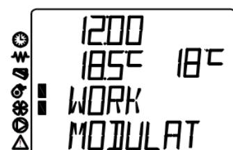
Podešavanje temperature vode u kotlu se vrši pritiskom na taster 1. Peć će grejati do te temperature i potom istu održavati. Zadavanje se vrši tako što se taster 1 pritisne kratko i potom pritiskanjem na taster 1 ili 2 se povećava ili smanjuje zadata temperatura vode. Ova radnja će biti propraćena ispisivanjem poruke **SET TEMP WATER**. Temperaturu je moguće menjati u intervalu od 20 do 80°C.
